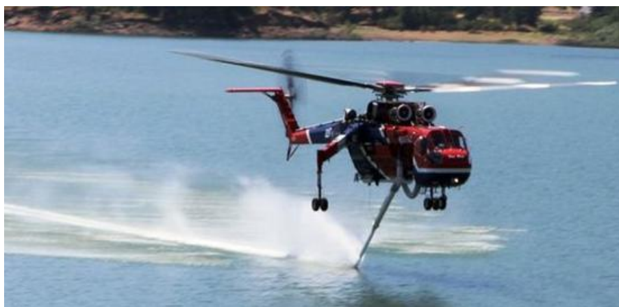
شکل ۲. بالگرد Sikorsky Air Crane در حال پر کردن مخزن از آب دریاچه [3]
