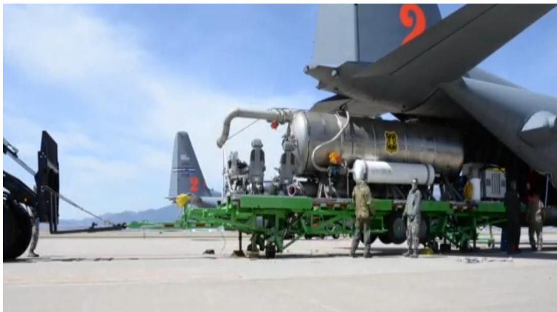
شکل ۱۷. نحوه بارگیری سامانه آتش‌نشان در هواپیما C-130 [10]
