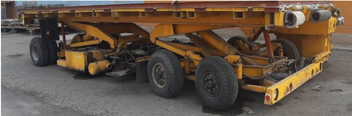
شکل ۱۲. "کی لودر" موجود در پایگاه یکم شکاری، جهت حمل تجهیزات AFFF
