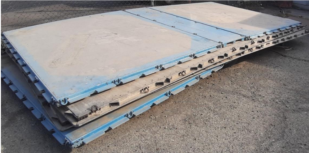
شکل ۱۶. دبل پالت جهت مهار کردن سامانه AFFF در داخل هوایمای
